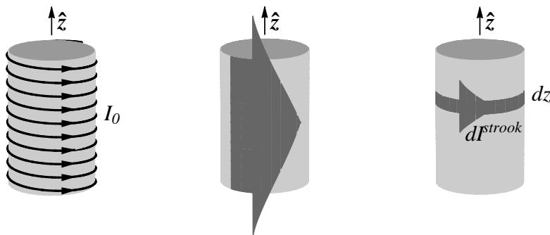
We vatten deze ideale cilindrische stroomspoel op als een benadering van een echte cilindrische stroomspoel (zie links), die bestaat uit  $n$  windingen per lengte-eenheid en een stroom  $I_0$  voert. In deze benadering geldt voor de stroom  $dI^{\text{strook}}$  door een smalle strook met breedte  $dz$  van de ideale stroomspoel (zie rechts):
