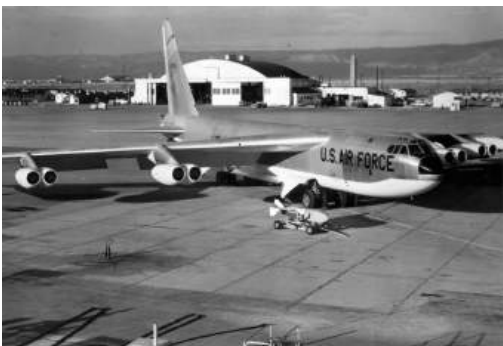
Boeing B-52D strategic bomber, voorzien van in totaal 8 turbojets. Merk op dat de diameter van de motoren klein is. De buik van het vliegtuig is "anti-flash white" geschilderd, om nucleaire thermische straling te reflecteren. Bron: https://w.wiki/_t72r .
